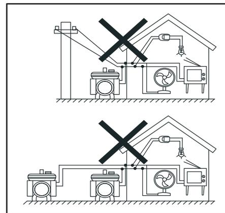
4) При необходимости использования изделия в качестве источника аварийного электроснабжения (в случае перебоев с подачей электроэнергии), подключите его к сети потребителей **ОБЯЗАТЕЛЬНО** через автоматический выключатель резерва.
