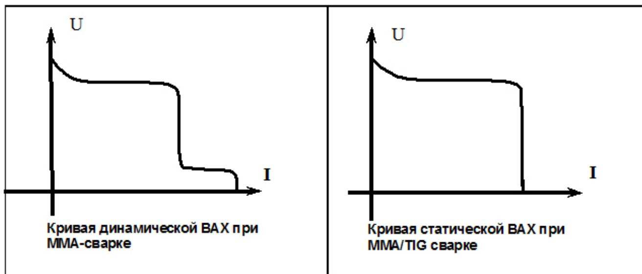
В этом сварочном аппарате применена технология самоограничения увеличения тока. Переменная составляющая тока не может быть видна из кривой статической вольт - амперной характеристики источника тока для сварки штучным электродом (ММА сварки), а, на практике, величина падения параметров тока будет автоматически добавляться в процессе сварки, решая проблему несоответствия степени увеличения тока при использовании
